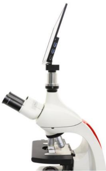
图 6 AIO-Cam 一体相机连接图
