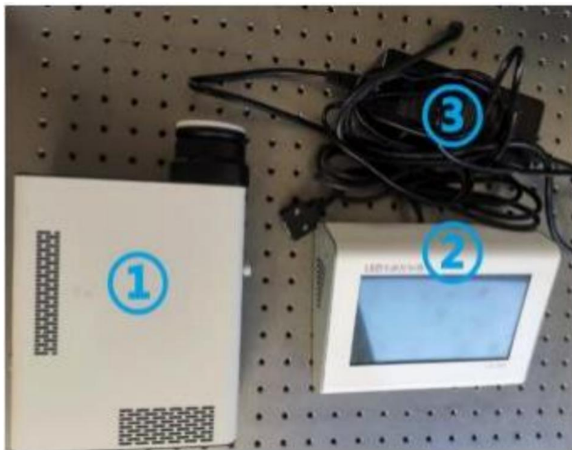
图 1 空间光输出光源(①光源 ②控制器 ③电源)
