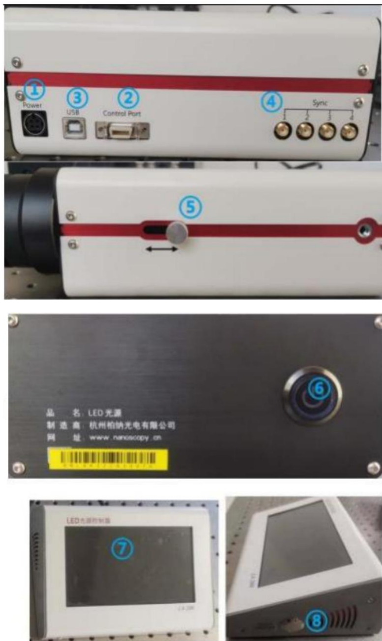
图 2 ①电源接口②可控制器接口③USB 接口④触发信号接口⑤调焦旋钮⑥光源开关⑦光源控制器⑧控制器开关
