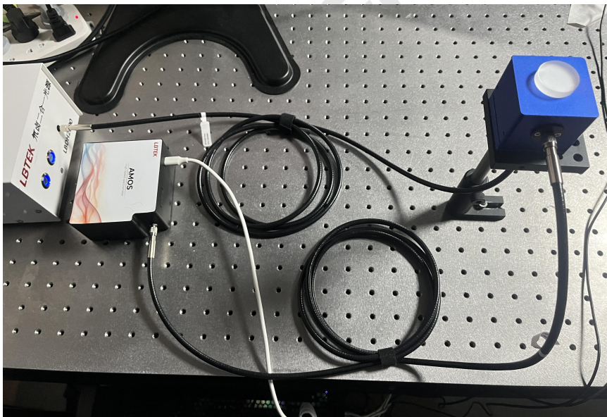
图 6 积分球倒置使用
