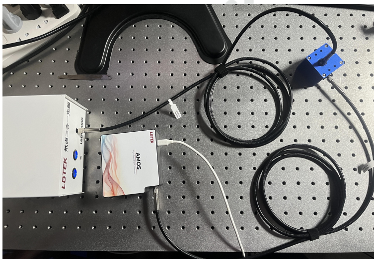
图 1 积分球测试反射光谱系统连接图
