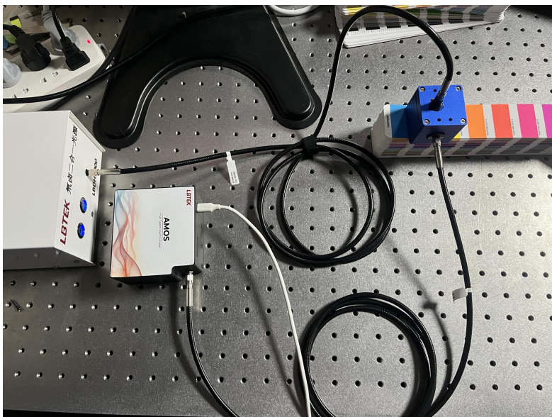
图 3 色卡反射光谱测试
