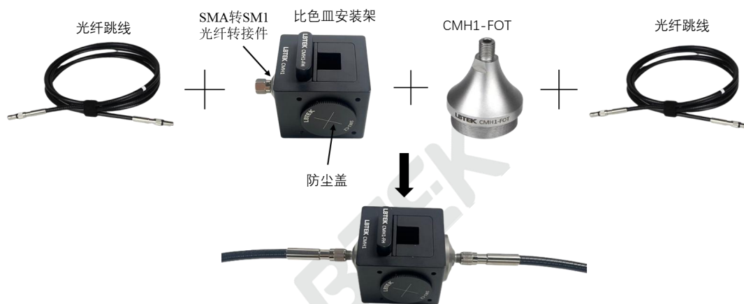
图 1 使用 CMH1-FOT 连接光纤和比色皿安装架
